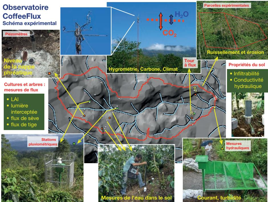
**Figure 2.2.** Dispositif expérimental de l'observatoire collaboratif CoffeeFlux dans la ferme d'Aquiaries : mesures et modélisations des flux de C, H<sub>2</sub>O, nutriments, de l'érosion, des services écosystémiques dans un système agroforestier à base de caféier.
